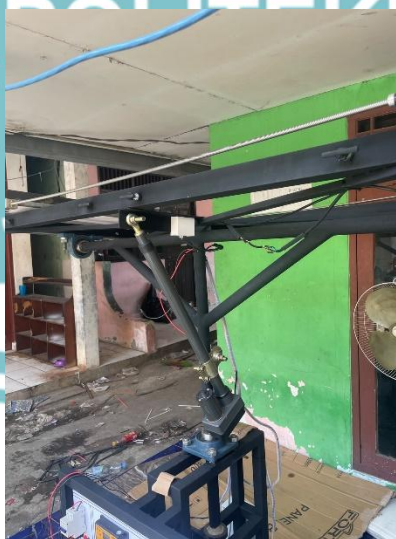
Gambar 3. 18 Aktuator linear (hidrolik)
