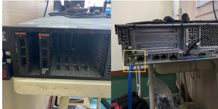
Gambar 3.10 Setup Slot SSD dan Konektivitas LAN Server
