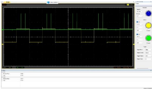
Gambar 13. Pengukuran Rangkaian ZCD Terhadap Gate SCR2
