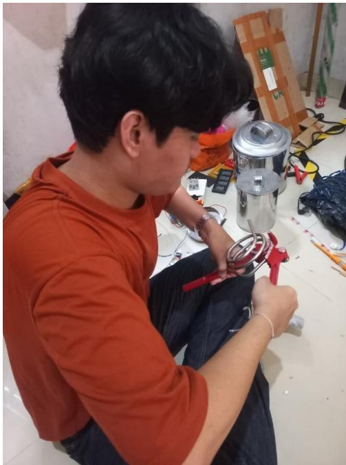
Pembengkokan Pipa Spiral
