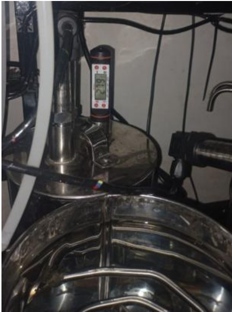
Uji Akurasi Sensor PT100 Menggunakan Thermometer
