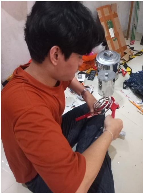
Pembengkokan Pipa Spiral
