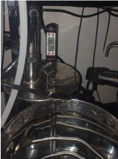
Uji Akurasi Sensor PT100 Menggunakan Thermometer
