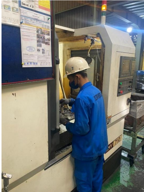
Keterangan: Memasang produk ke dalam jig proses dan clamp produk dengan tuas hidrolik
