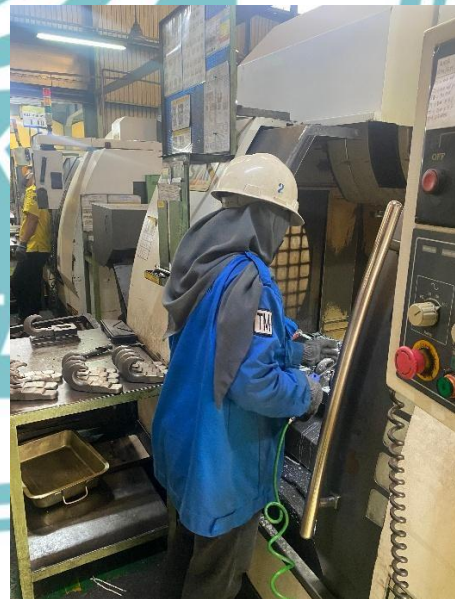
Melakukan proses pengambilan produk Di mesin Mill Star MV-820
