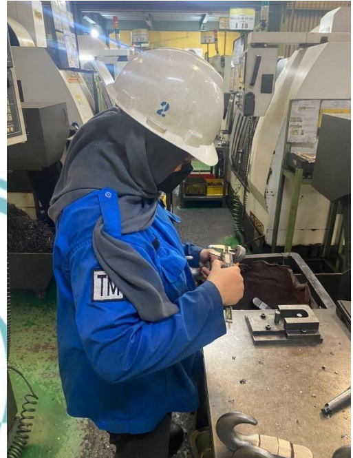
Melakukan pengukuran hasil produk menggunakan V. Caliper
