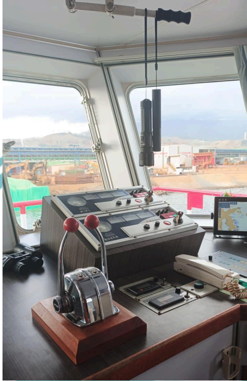
Lampiran 7. Alat Navigasi Anjungan Kapal Tugboat
