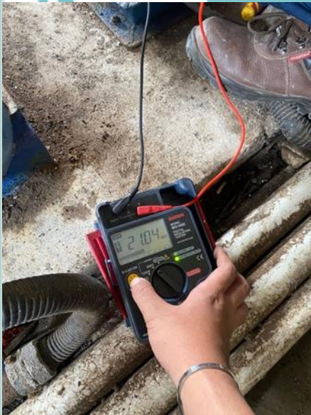
Lampiran 4. Maintenance Kelistrikan Motor Listrik Menggunakan Tahanan Isolasi Magger
