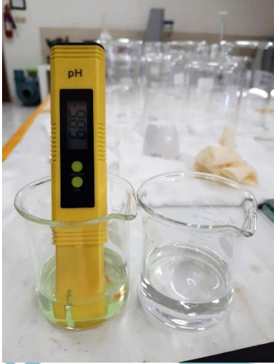
Kalibrasi pH meter dengan cairan kalibrasi pH 7 dan pH 4
