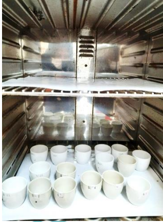
Cawan kosong dikeringkan dengan cara pemanasan dalam oven selama 30 menit
