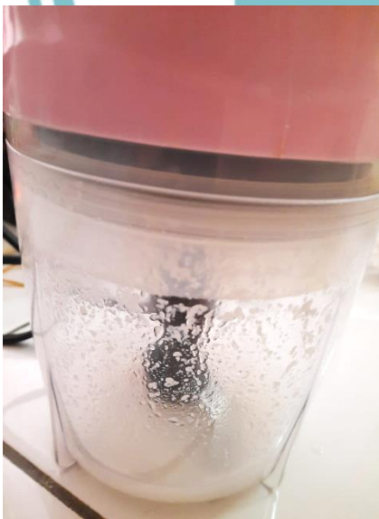
Penghalusan sampel yang ditambah aquades dengan blender
