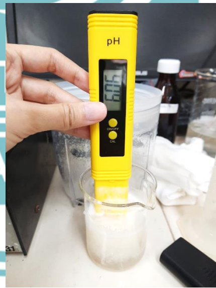
Pengukuran sampel menggunakan pH meter
