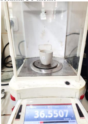
Cawan kosong dikeringkan dengan cara pemanasan dalam oven selama 30 menit
