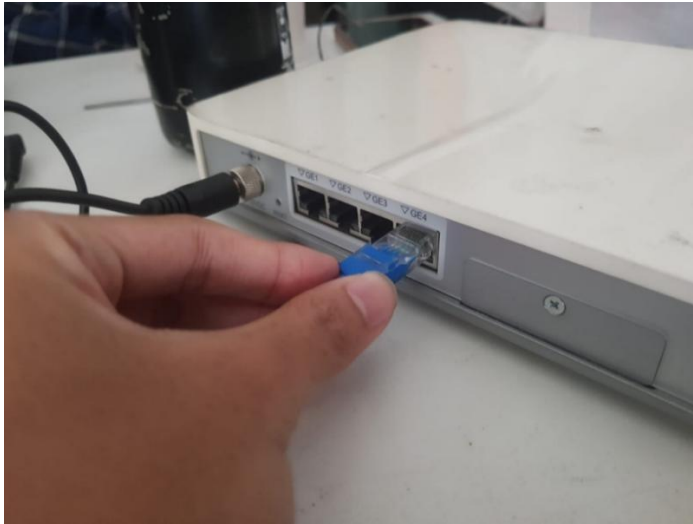
Gambar 3.3.2.29 - Menghubungkan SD-Wan ke Internet provider
