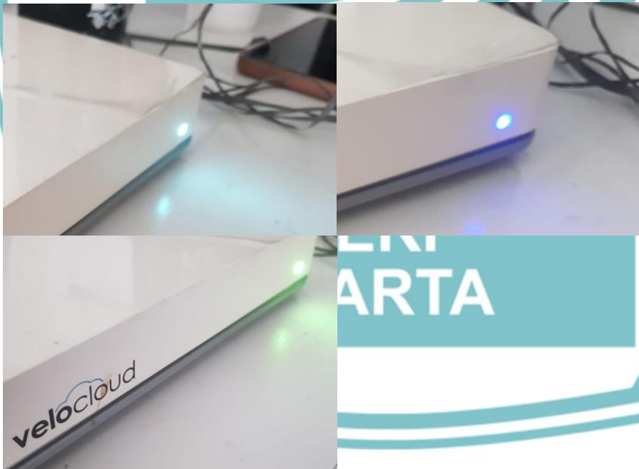
Gambar 3.3.2.30 - Lampu indikator perangkat SD-Wan
