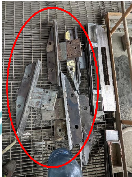
Gambar 1. 2 Mounting Strap yang aus
