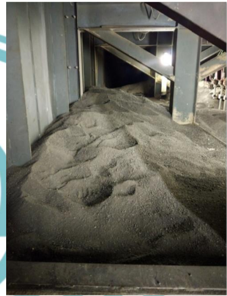
Gambar 1. 1 Klinker yang menumpuk dibawah compartment cooler
