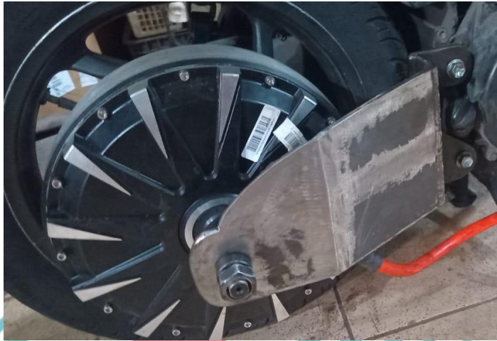
Lampiran 6 Gambar 6.5 BLDC yang terpasang sempurna dengan Custom Arm
