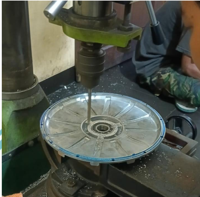
Lampiran 6 Gambar 6.3 pembuatan drat pada left cover BLDC
