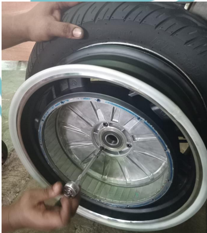
Lampiran 6 Gambar 6.4 pengujian kecocokan left cover dengan Velg
