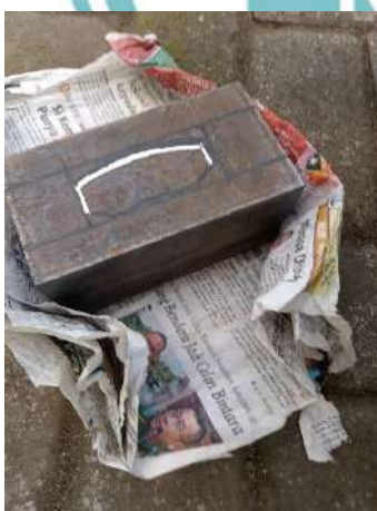
Proses marking cetakan kampas rem
