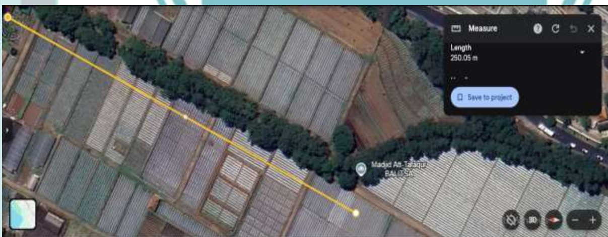
Pengukuran LOS Jarak 250 meter
