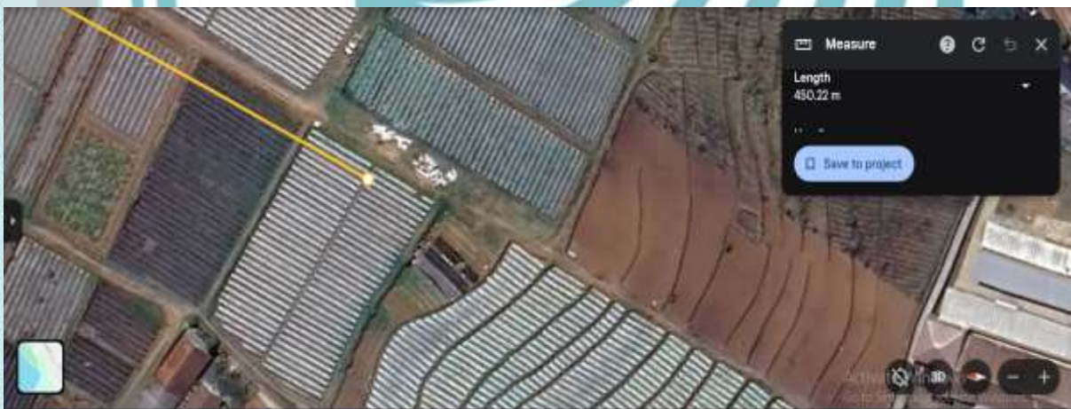
Pengukuran LOS Jarak 450 meter
