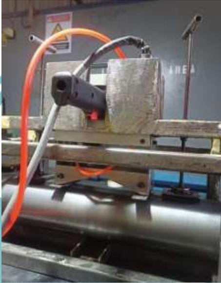
Lampiran 1. 1 Pengerjaan menggunakan alat bantu *marking*.
