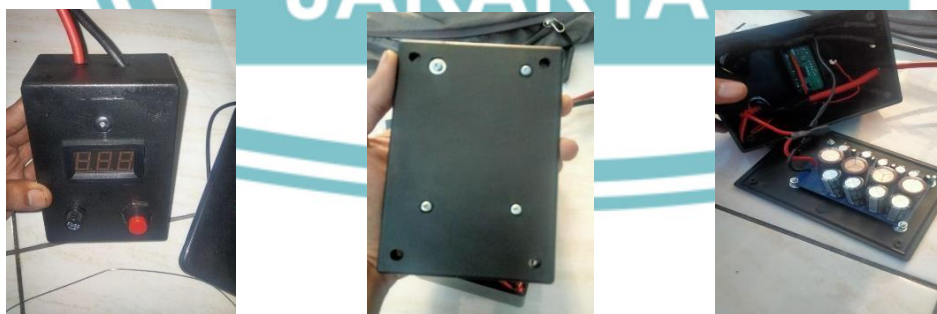
Proses modifikasi box project dan pengabungan PCB
