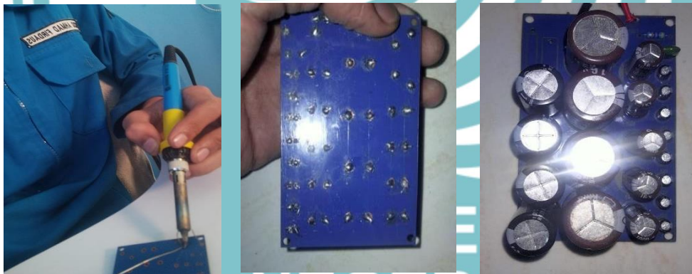
Proses dan hasil perakitan voltage stabilizer menggunakan solder
