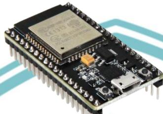
Gambar 2. 3 Mikrokontroller ESP32
