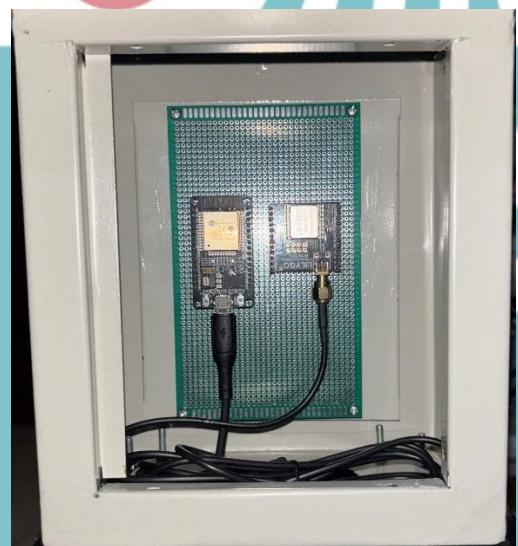
Gambar 3. 12 Bagian dalam panel box *receiver*
