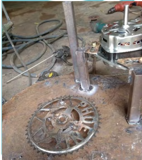
Lampiran 4 Pemasangan Motor Electric
