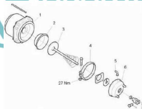
Gambar 2. 1 Komponen Brake Chamber
