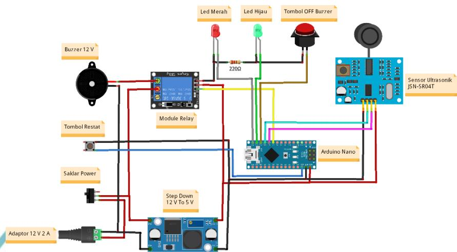
Gambar 3. 8 Skema Rangkaian Mikrokontroller
