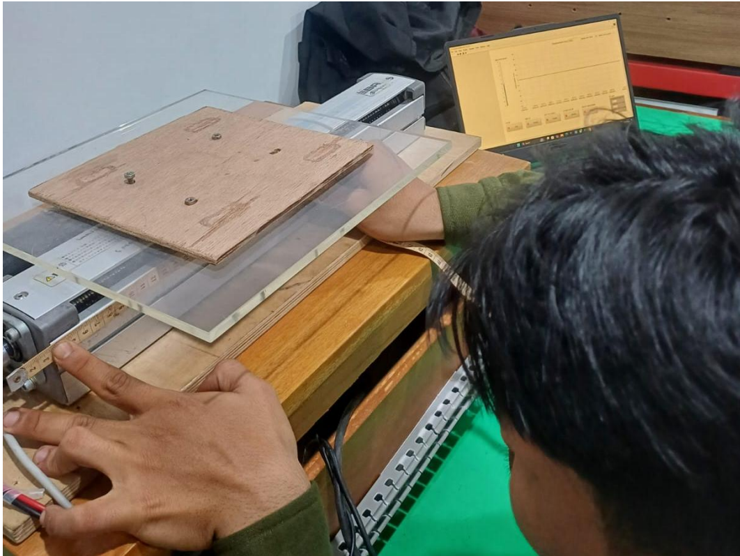
Gambar 1. Membandingkan Spesifikasi Perubahan Posisi Linear Guide Block dengan Hasil Pembacaan Sensor dengan Pengukuran Meteran Baju.
