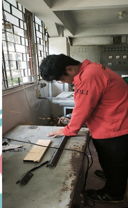
Proses pemotongan train rail untuk panel utama
