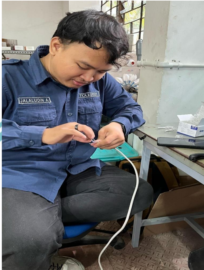
Proses crimping kabel komunikasi RS-485 dan juga kabel LAN
