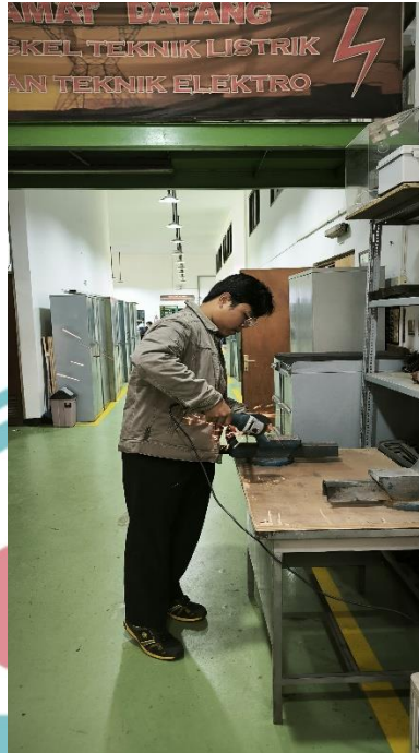
Proses pemotongan siku untuk mekanik motor
