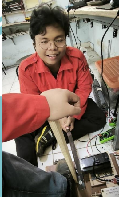
Dokumentasi 1 Pengikiran shaft generator
