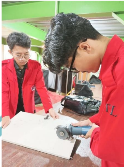
Proses Melubangi Panel untuk LCD I2C
