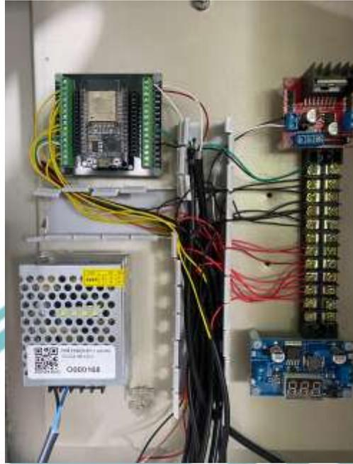
Gambar 3. 10 Gamabr Wiring Dalam Panel
