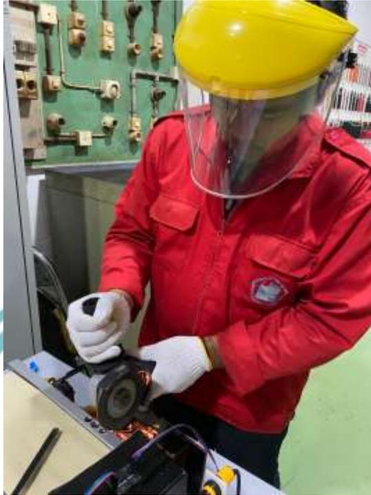
Gambar 3. 7 Gambar pemotongan konveyor
