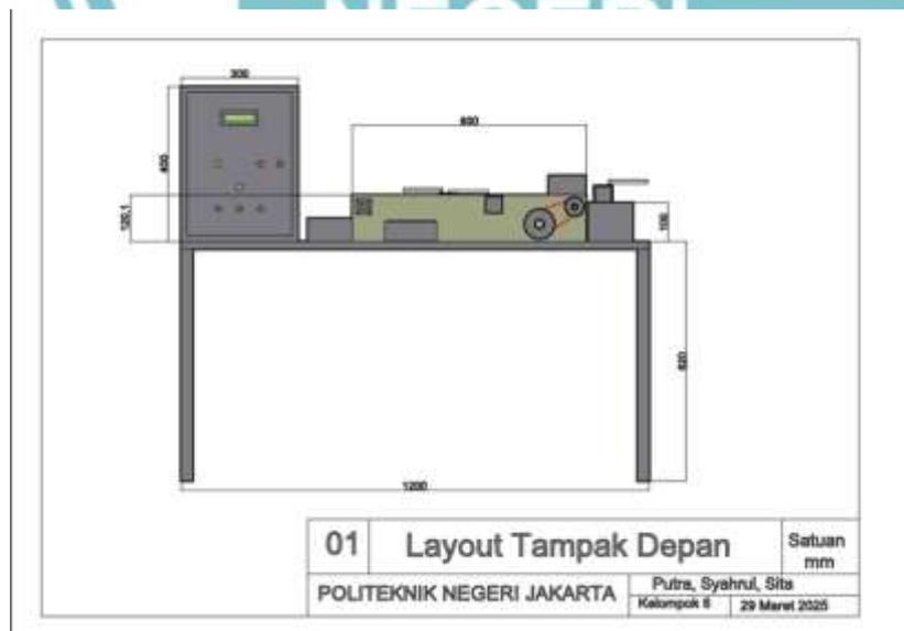
Gambar 3. 11 Gambar Desain seluruh alat
