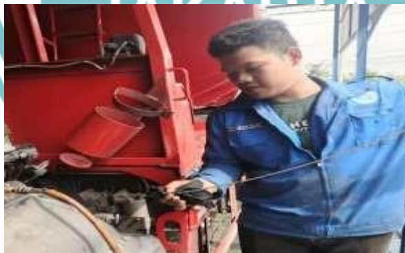
Pengecekan Lever Oli Mesin
