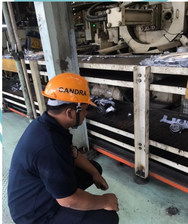
Lampiran 5 Menganalisi putus pada Slat Conveyor
