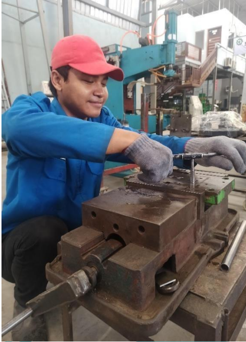
Proses Pengetapan Ulir Dalam Dies Yang Aus
