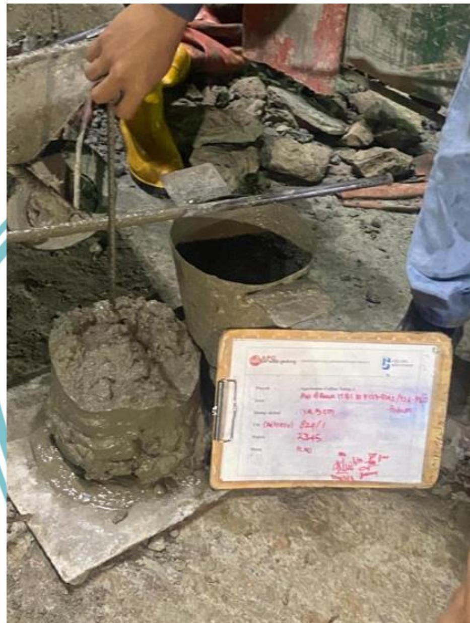
Gambar 4.45 Hasil Uji Slump
