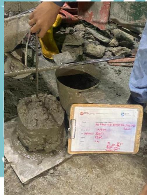
Gambar 4.39 Uji Slump
