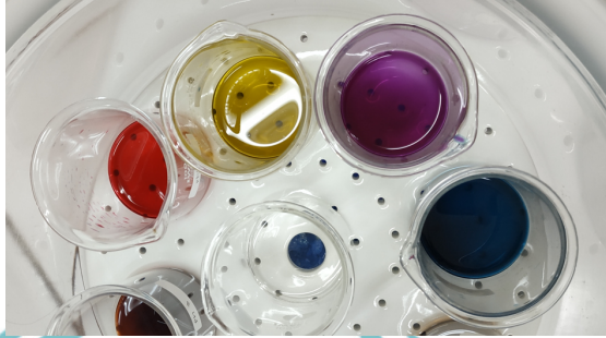
Larutan ekstrak kubis merah sebelum pengujian sensitivitas gas amin
