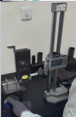
Praktik pencarian koordinat CNC menggunakan Dial Gauge Indicator.
