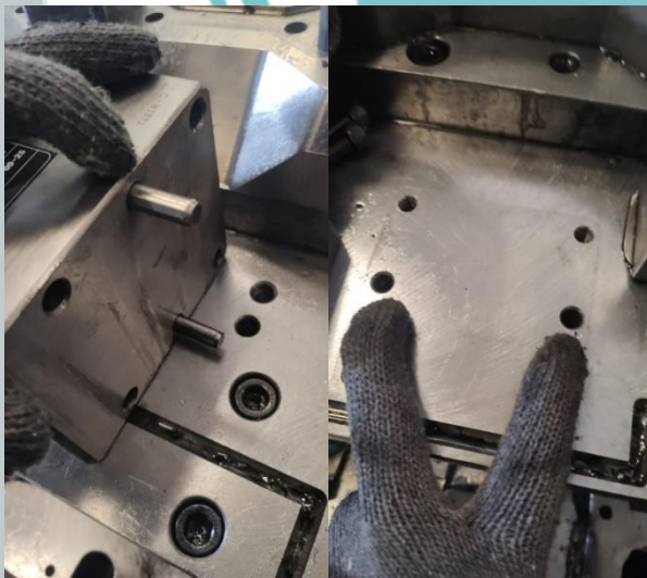
Dowel pada Mounted CAM Dies dan Lubang dowel pada Profil dies .
