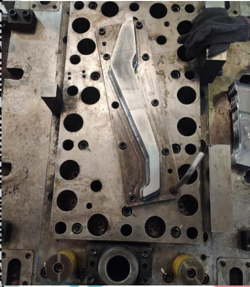
Machining Wirecut pembuatan Punch cutter.
