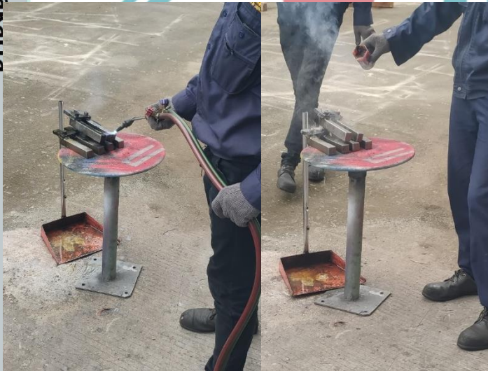
Hardening clamp dies dengan Quenching oli.
