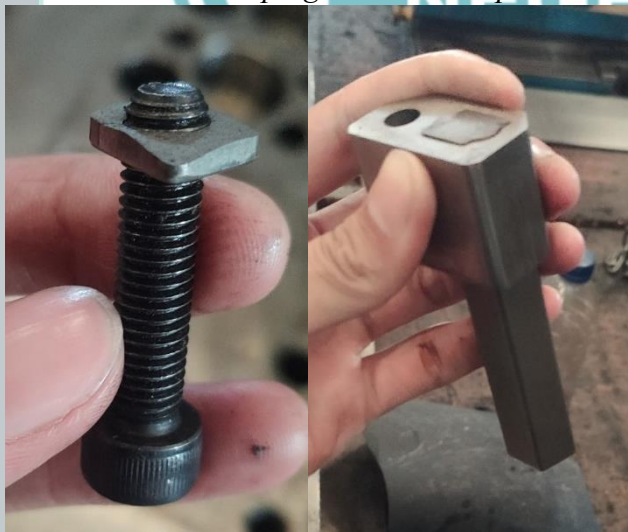
Patahan Punch stamping cutter dan improvement cutter dengan stopper.
