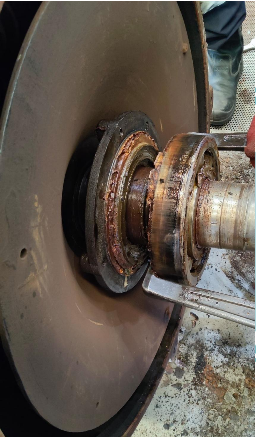
Lampiran 14 Pelepasan Pulley / Hub Kopling Menggunakan Hidrolik Jack
