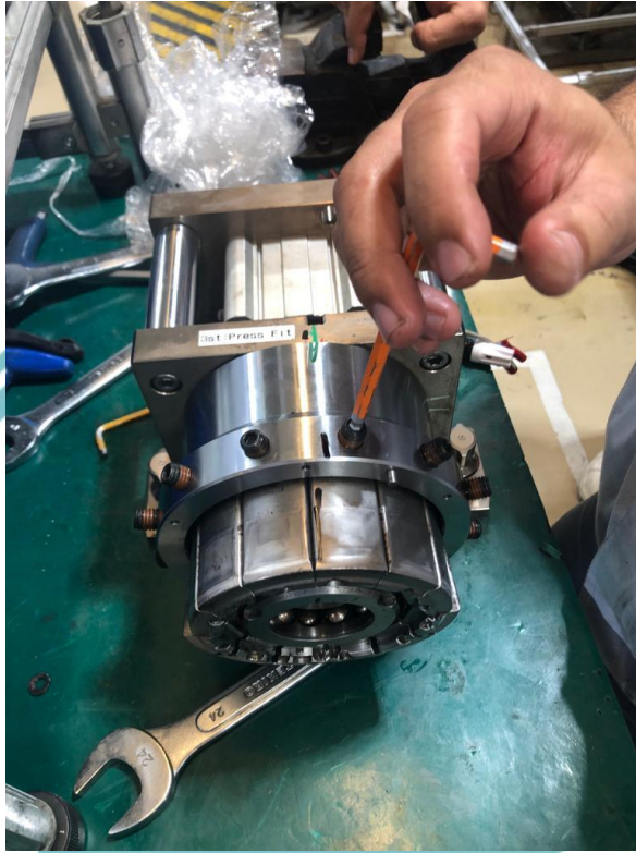
Lampiran 3 Pembongkaran Spring Chuck
