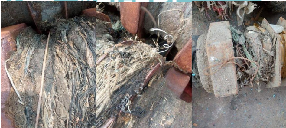
Gambar 1. 2 Disc screen yang terlilit oleh material logam yang bergesekan dengan disc screen lain
