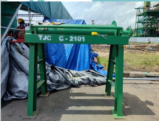
Lampiran 7. Spiral Steel Bar Bending sebelum dilakukan Redesign
