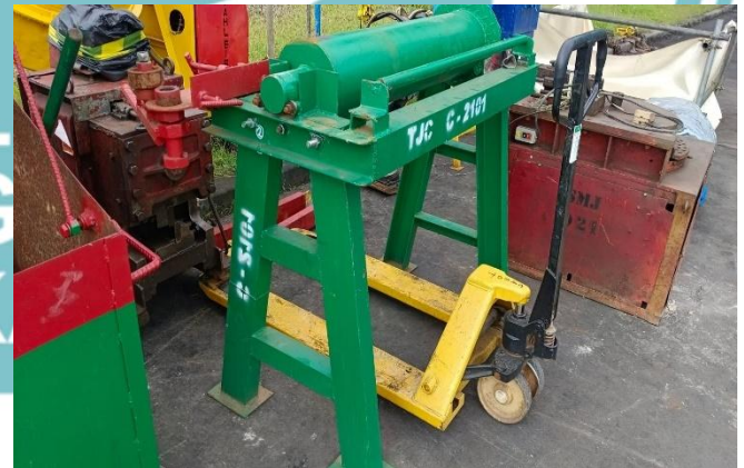
Lampiran 7. Spiral Steel Bar Bending sebelum dilakukan Redesign
