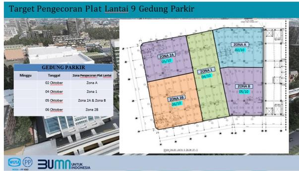
Gambar 3. 37 Target Pengecoran Mingguan
