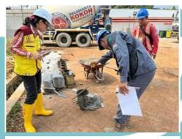
Gambar 3. 69 Pengujian Slump
