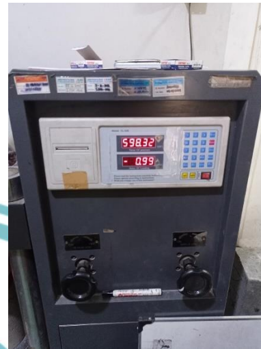
Gambar 3. 18 Pengujian Uji Kuat Tekan Beton
