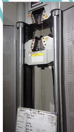
Gambar 3. 19 pengujian Kuat Tarik dan Kuat Geser Las Besi Wiremesh
