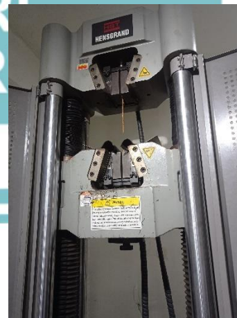
Gambar 3. 19 pengujian Kuat Tarik dan Kuat Geser Las Besi Wiremesh
