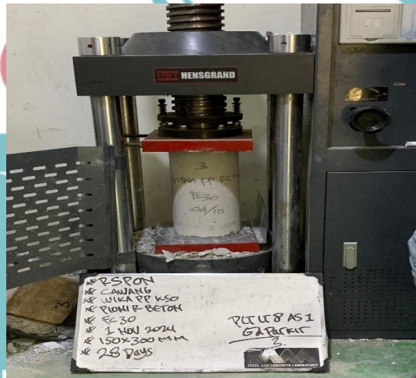
Gambar 3. 39 Pengujian Kuat Tekan Beton
