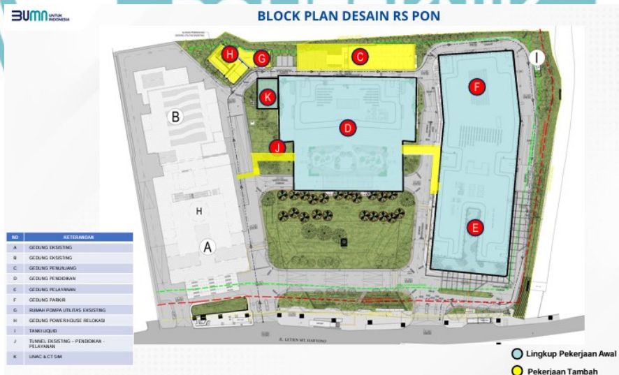
Gambar 3. 6 Lingkup Pekerjaan Proyek RS PON Jakarta Sumber : Dokumen Proyek
