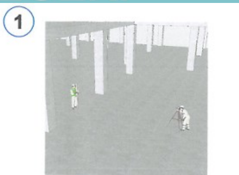
Marking posisi dinding dan kolom praktis
