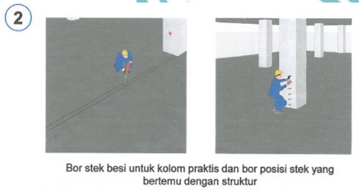
Gambar 3. 64 Pemasangan kolom praktis
