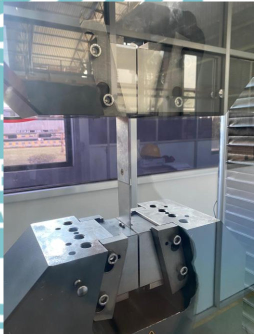
Gambar 0.8 Spesimen dilakukan uji tarik
