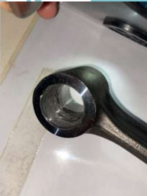
Lampiran 2 Rod Connecting dan Holder yang rusak
