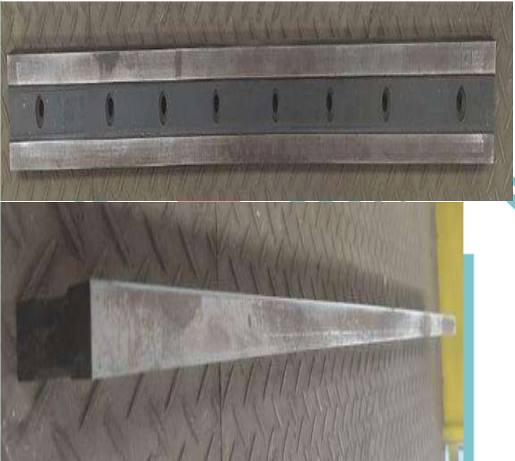
Lampiran 3. Shear Blade yang mengalami kerusakan
