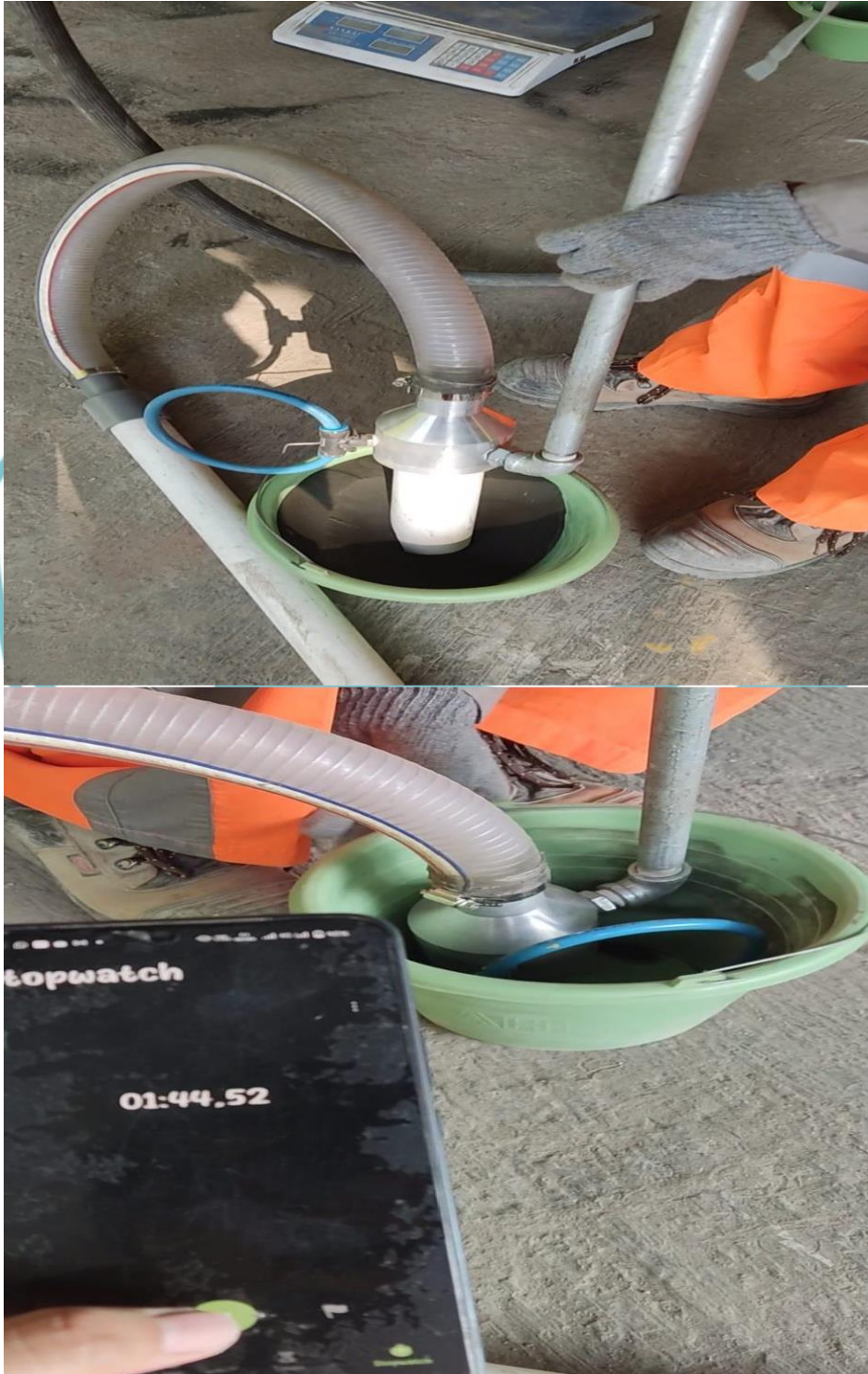
Lampiran 10 : Simulasi ke-3 menggunakan inlet PVC 10[cm] dan tanpa PVC
