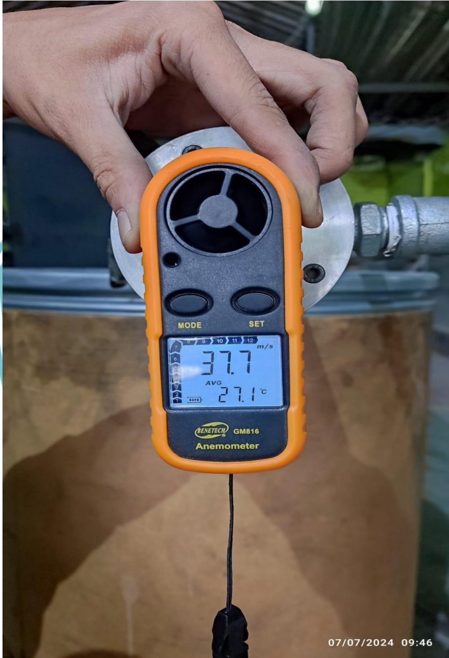
Lampiran 14 : Menghitung Kecepatan Angin menggunakan Anemometer
