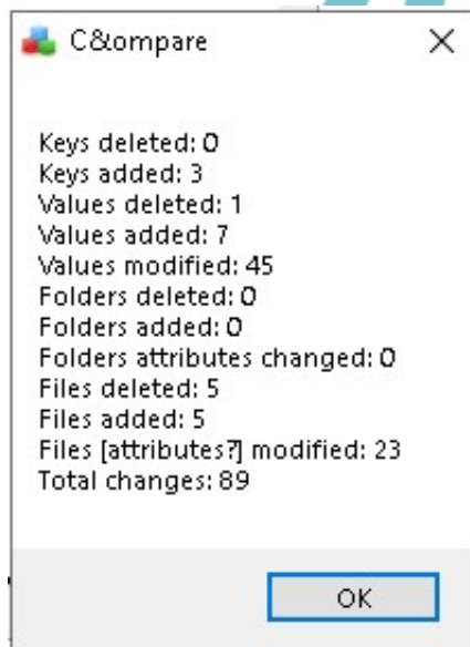
Gambar 4. 26 hasil komparasi sebelum dan sesudah aplikasi pembersih malware Slackbot dieksekusi oleh 'regshot'
