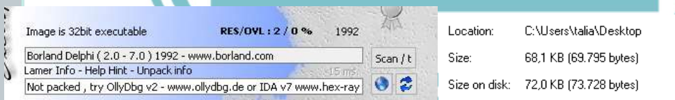
Gambar 4. 3 cek file sampel 1 menunjukkan sudah tidak lagi packed sehingga ukuran file bertambah
