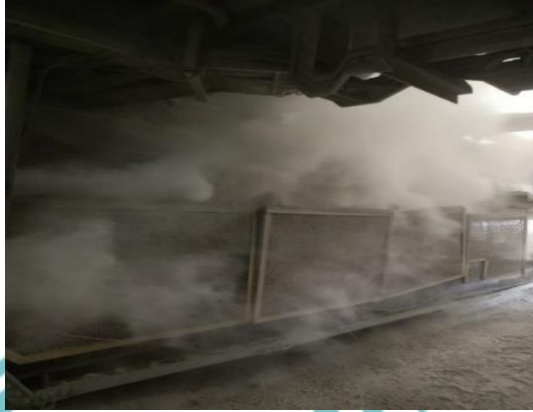
Gambar 1.2 Kondisi Dusty pada Belt Conveyor 532-BC3
