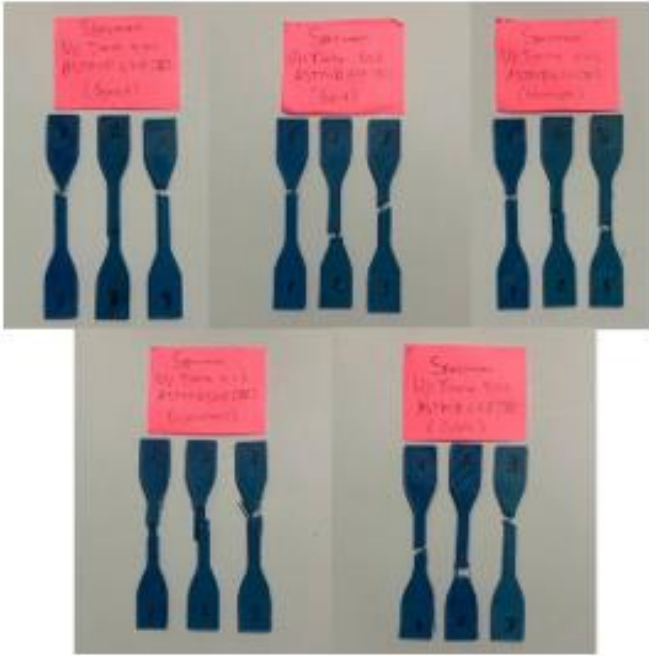
Hasil Patahan Uji Tarik Sampel 50%
