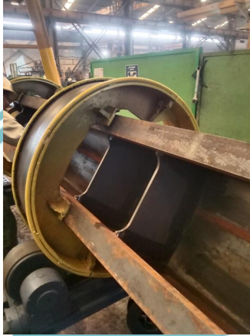
Lampiran 1 Pemasangan inner roll pada sideframe untuk pengelasan
