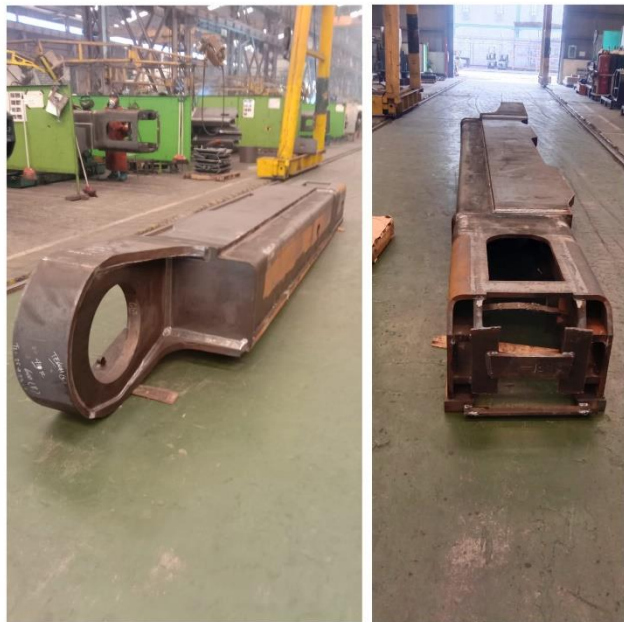
Lampiran 6 Siframe yang sudah di welding
