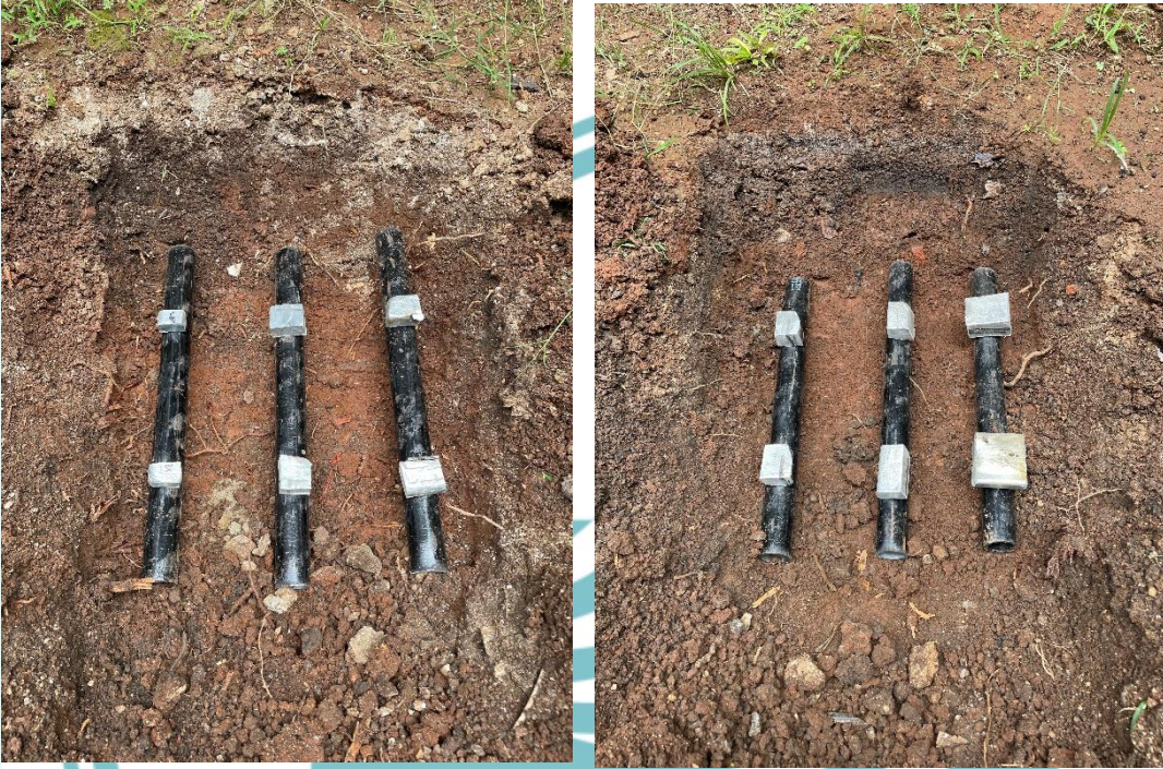
Lampiran 4 Penempatan Anoda Korban Magesium, Alumunium, dan Magnesium
