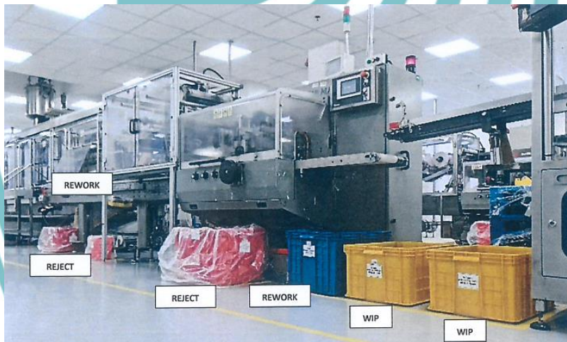
Layout Penempatan Wadah di Mesin Bignose
