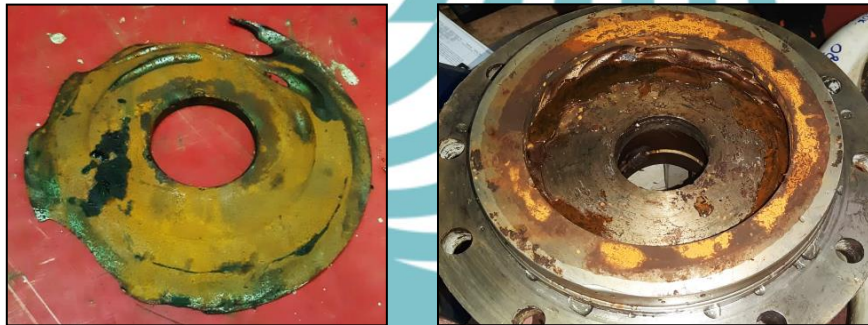
Gambar 1. 2 Kerusakan pada Pedestal Cover dan Pedestal pada pompa Overhung 4x11 Sumber : Dokumentasi PT. XYZ
